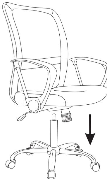
※シリンダーの先端を座裏プレート中央の穴に真上から重ねます。
